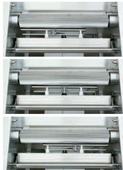
NOCK Air-Jet Druckluft-Reinigungssystem: Die Düsenstange wird durch einen gekapselten Pneumatik-Zylinder bewegt.
