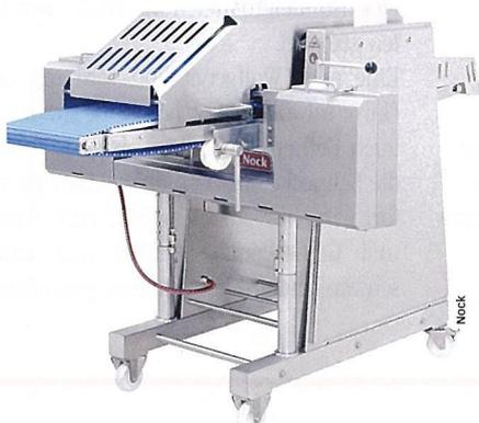
**Der neue CB 435/4E HVC Horizontal-Vertical-Cutter liefert einen horizontalen Schnitt plus vertikale Schnitte oder aber auch nur einen horizontalen Schnitt oder nur vertikale Schnitte.**
