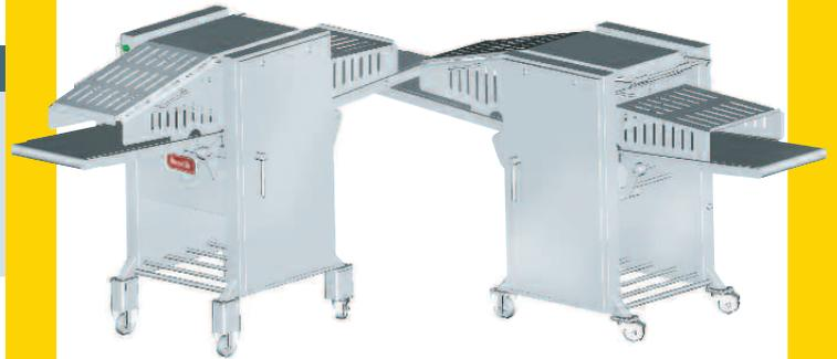
Würfel, z.B. aus Hähnchenbrustfilets, können in einem zweiten Durchlauf oder mit zwei im Winkel von 90 Grad stehenden Maschinen geschnitten werden. Die Übergabe von der ersten auf die zweite Maschine erfolgt automatisch und erfordert keinen Bediener.
