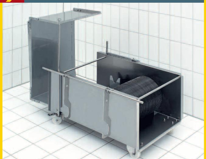
Reinigungswagen für 2 Messerwalzen (Haube geöffnet, Aushebevorrichtung eingehängt)
