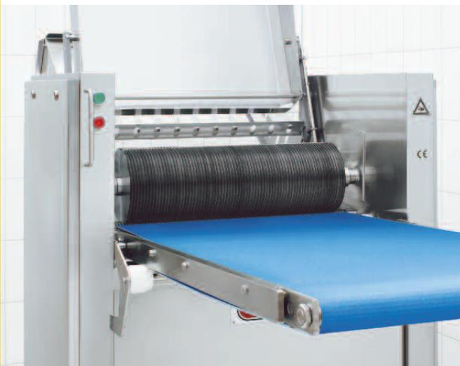
Cortex CB 495/7K SLICER 200 mit 200 mm Messerdurchmesser und 8 mm Messerabstand; Sicherheitsabdeckhaube geöffnet.
