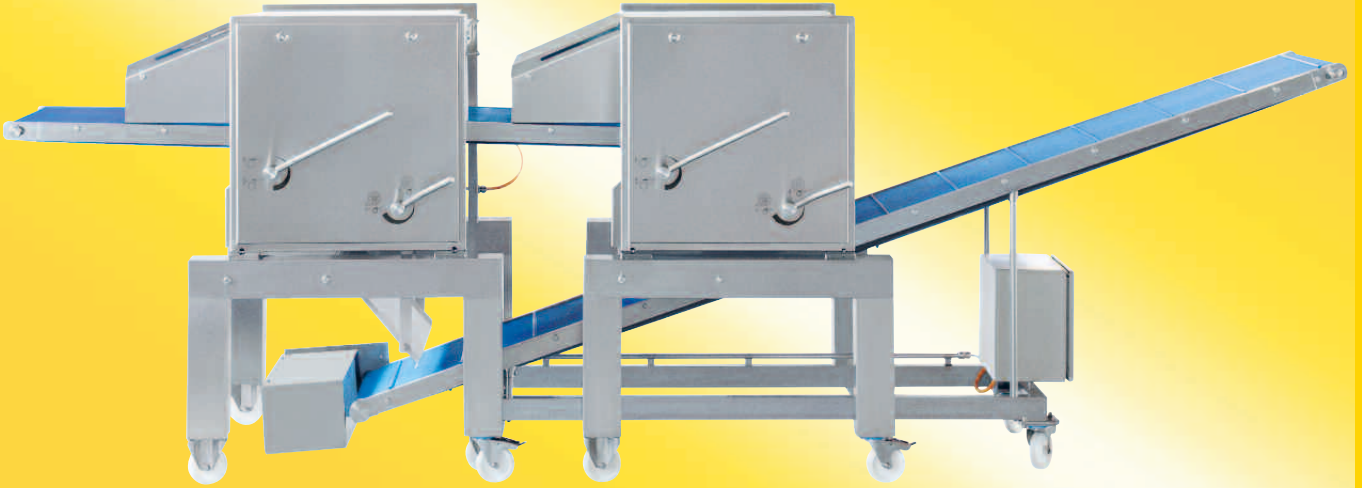
Kesilmiş olan et için sevk bantlı Cortex CB 503 KEBAB DUO kesme sistemi
